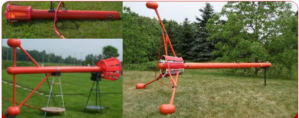
Magnetómetro GSMP-35A (B), Gradiómetro Vertical GSMP-35GA (B), y Gradiómetro Triaxial GSMP-35GA3 (B). (Basado en el más reciente sensor aerotransportado de alta resolución GSMP-35A v8,0)
